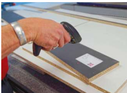
Per Handscanner identifiziert die CNC das Werkstück
