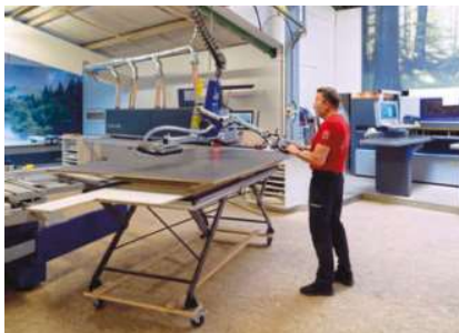
Den Hubwagen kann er leicht an die Höhe der nachfolgenden Maschinen anpassen
