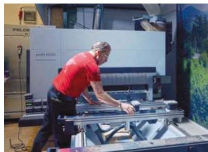
Nach Bildschirminstruktion positioniert Holger Sieber die Traversen und Sauger
