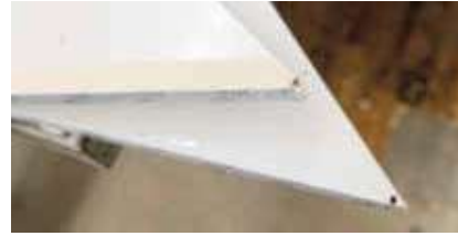
Bei Schrägteilen weiß die Steuerung nicht, wo der Kappschnitt sitzen muss
