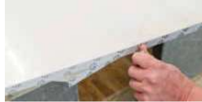
Abhilfe schafft das vorübergehende Verlängern des Werkstücks
