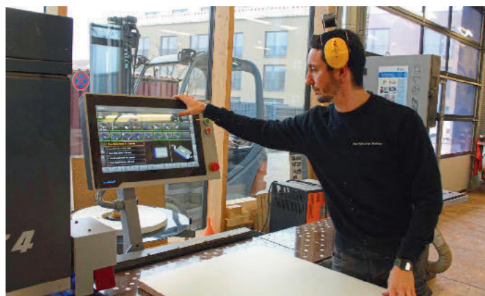
/ Automatisierte Kantenbearbeitung mit der Tempora 800 von Format 4: Jesse Dix wählt das Bearbeitungsprogramm und los geht's.
