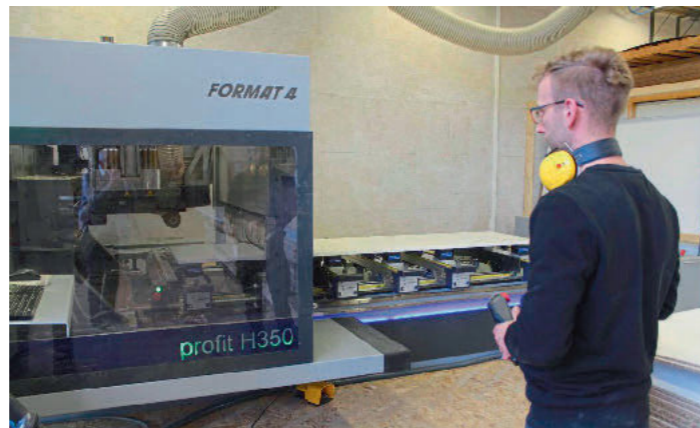
/ Das 5-Achs-CNC-Bearbeitungszentrum Profit H 350 von Format 4 zeigt sich als leistungsfähiger Allrounder.
