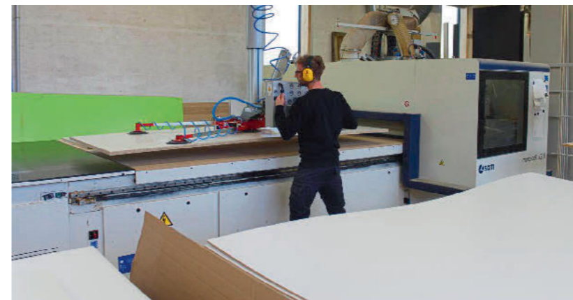
/ Zwei Maschinen in einer: Die Nesting-CNC von SCM leistet bei Fortner auch den kompletten Plattenzuschnitt.
