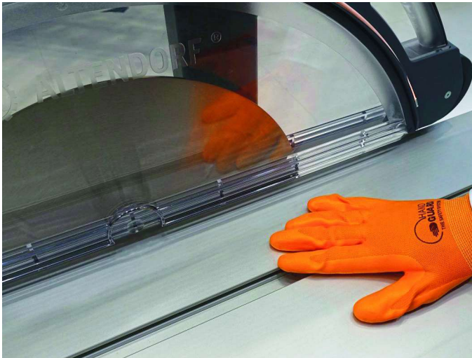
2 Gelbe Karte! Der Abstand zum Sägeblatt liegt deutlich unter 120 mm und das Tragen von Handschuhen ... Hand Guard passt auf!
