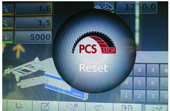
5 ... und Reset erscheint markant auf dem Touchscreen. Quittieren und die Maschine ist in weniger als einer Minute wieder startklar
