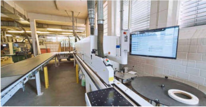
/ Kante gut, alles gut: Vor drei Jahren investierte die Tischlerei in die Kantenanleimmaschine Edgeteq S300 von Homag samt Rückführung für den 1-Mann-Betrieb.
