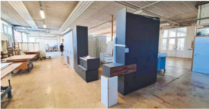
/ Im Bankraum wird vormontiert, damit auf der Baustelle alles glatt läuft. Hier hat jeder Mitarbeiter seinen eigenen Arbeitsplatz samt Werkzeug und Hubtisch.
