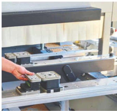
/ Die Sauger werden genau an der Stelle positioniert, die der Laser, der von oben strahlt, vorgibt.
