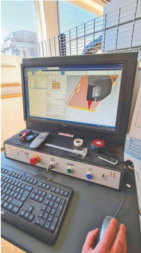
/ Direkt an der CNC werden die Daten aus Palette CAD in der CAD/CAM-Software F4 Create weiterverarbeitet.
