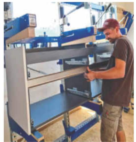
/ Multi Press von Barth: dient zum Verleimen von Korpusen und als ergonomischer Montagetisch.
