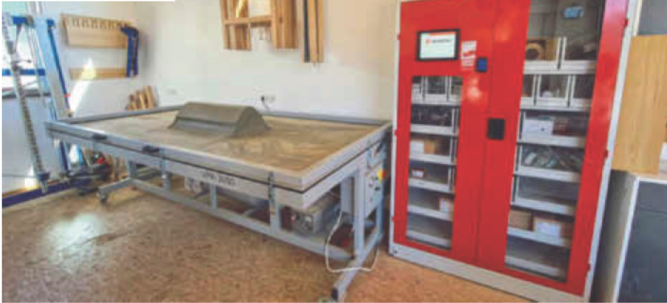
/ Formteile werden bei der Schreinerei mittels Vakuumtechnik erstellt. Die VPR 3000 leistet seit Jahren gute Dienste. Neu ist der Verbrauchsmittelautomat von Würth, der selbstständig den Verbrauch ermittelt und sogar nachbestellt.
