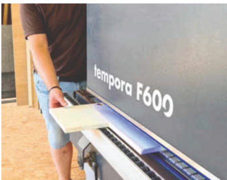
/ Die Kantenleimmaschine Tempora F600 arbeitet mit EVA- oder innovativem PUR-Kleber von der Rolle.
