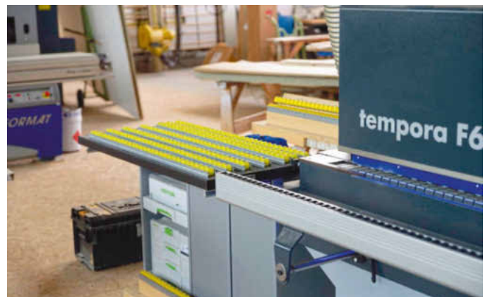
Der selbstgebaute Röllchentisch am Maschinenauslauf erleichtert die Einmannbedienung
