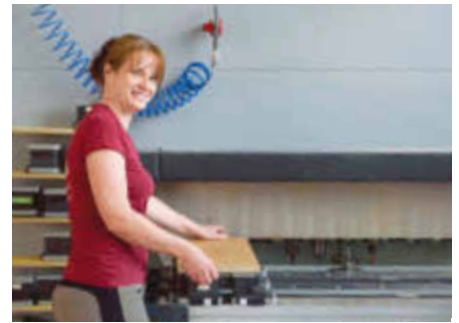
Simone Heinze hat das Etikett eingescannt und spannt die Platte auf die CNC
