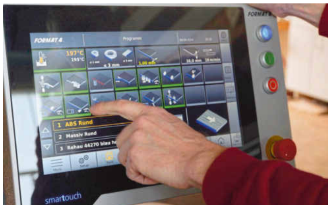
Über diesen Touchscreen lassen sich alle Bearbeitungsvorgaben wie z. B. das Kapfen an der Vorderseite ganz einfach einstellen
