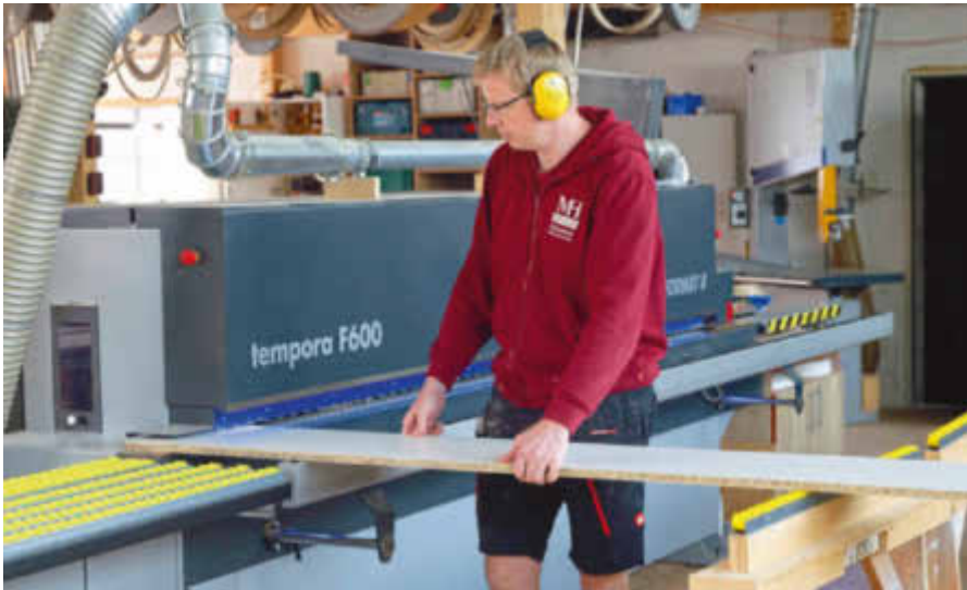
Auf Böcke aufsteckbare Röllchenbahnen geben zusätzlichen Halt
