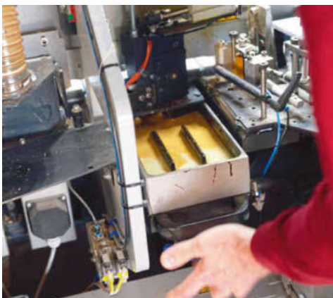
Michael Heinze baut das Beleimaggregat mit transparentem Kleber aus
