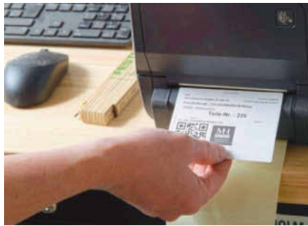
Jedes Teil erhält ein später an der CNC einzuscannendes QR-Codeetikett
