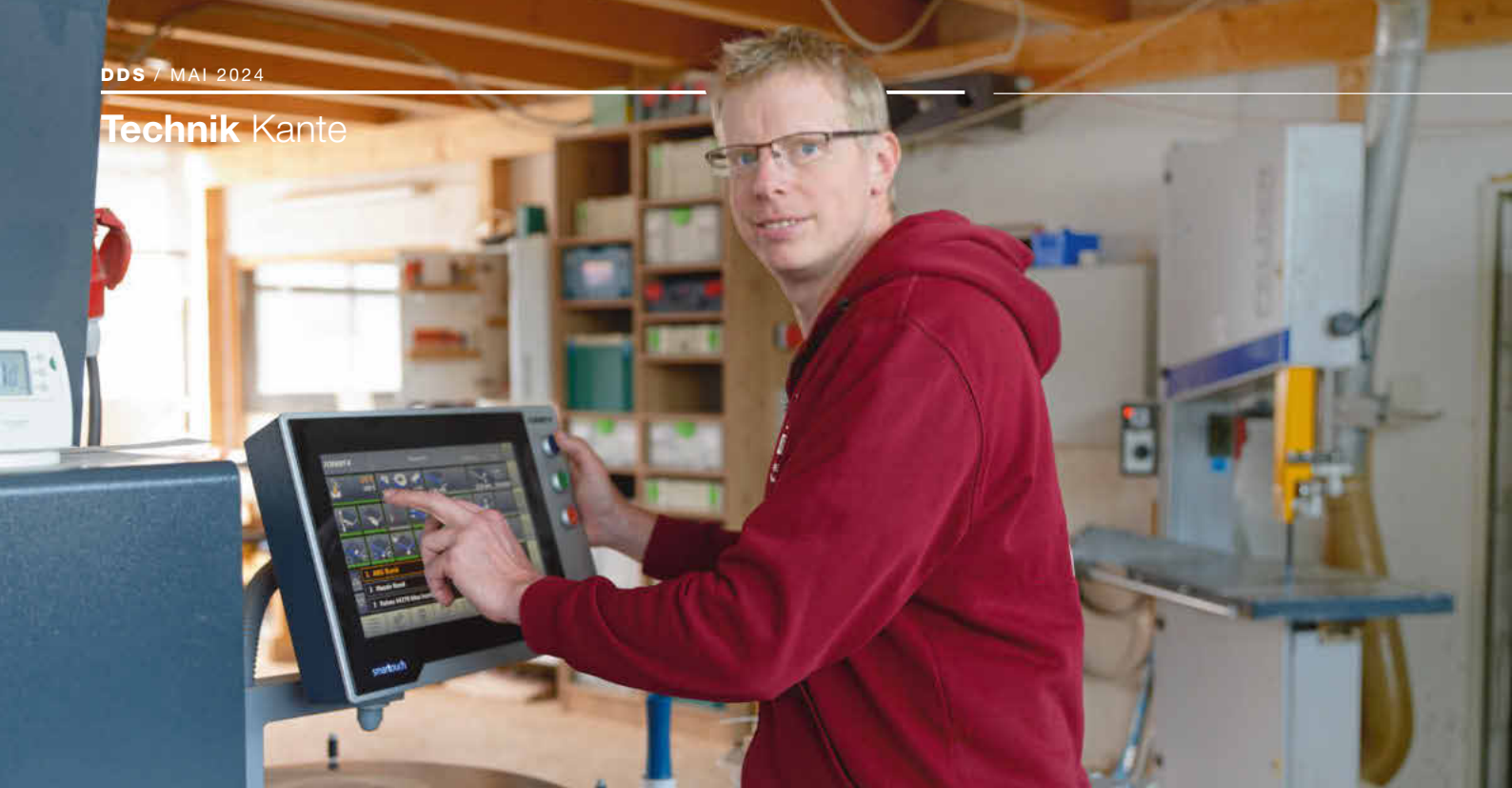
Michael Heinze bedient seine Kantenanleimmaschine nur über den Touchscreen
